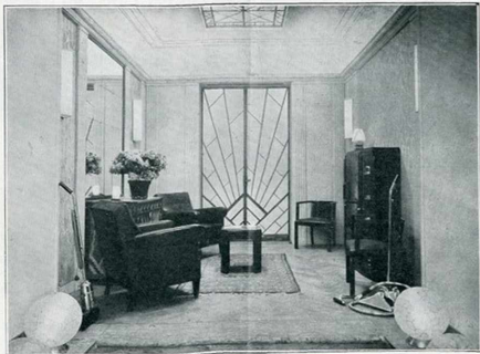
FIG. 5. — Le salon dont l'éclairage particulièrement soigné est obtenu par corniche et appliques en verre nacré. Cette salle est chauffée par un poêle à accumulation dissimulé derrière un cache-radiateur en fer forgé.
